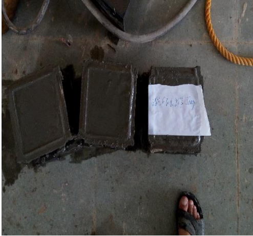
Fig.7 25% Fly ash + 25% slag
